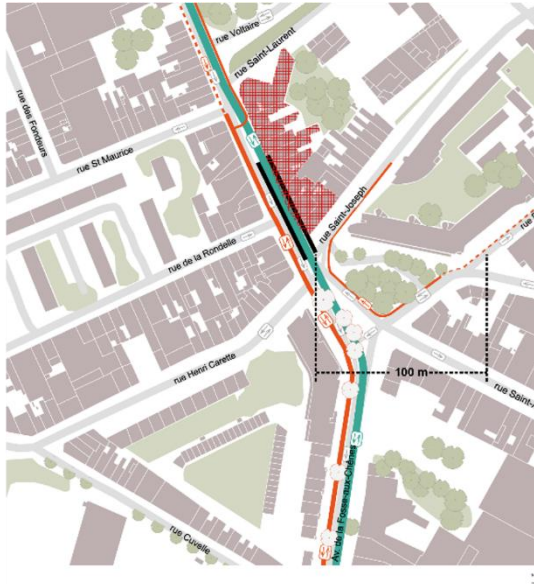
Scénario 2 Quai-trottoir, 1 sens voiture Démolition est
